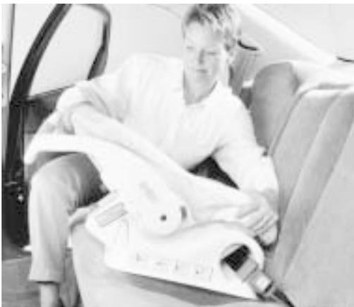
3. Si nécessaire, après avoir installé le siège d'enfant dans la base, pousser et tirer le siège d'enfant vers l'avant et d'un côté à l'autre pour confirmer qu'il est attaché assez solidement pour rester en place pendant les manoeuvres normales de la conduite. Si le siège n'est pas solide, répéter ces étapes.
