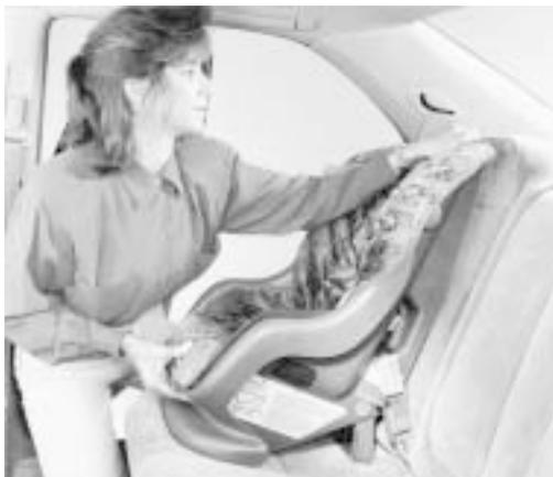
4. Pousser et tirer le siège d'enfant vers l'avant et d'un côté à l'autre pour confirmer qu'il est attaché assez solidement pour rester en place pendant les manoeuvres normales de la conduite. Si le siège n'est pas solide, détacher la ceinture de sécurité, la laisser s'enrouler complètement, puis répéter ces étapes.
