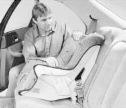
6. Pousser et tirer le siège d'enfant vers l'avant et d'un côté à l'autre pour confirmer qu'il est attaché assez solidement pour rester en place pendant les manoeuvres normales de la conduite. Si le siège n'est pas solide, répéter ces étapes.
