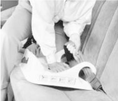
2. Tirer fermement sur le bout libre de la ceinture pour serrer la ceinture comme il faut. Mettre du poids sur le siège d'enfant et pousser sur le dossier du siège d'enfant tout en tirant sur le baudrier peuvent aider à attacher le siège solidement.
