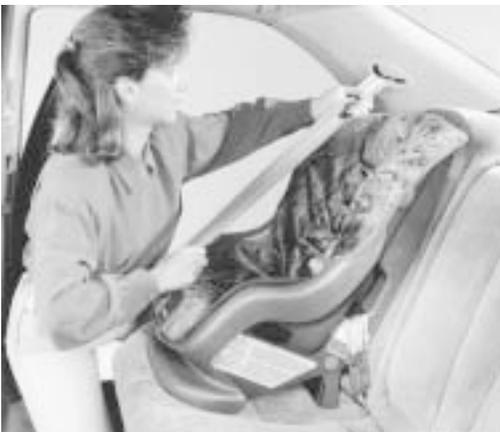
2. Tirer le baudrier de la ceinture jusqu'à l'arrêt puis laisser la ceinture s'enrouler (vous entendrez peut-être un bruit pendant que la ceinture s'enroule). Une fois que la ceinture est enroulée, tirer sur la ceinture. Si la ceinture est bloquée, vous ne pourrez la sortir. Si vous pouvez la sortir, la ceinture n'est pas bloquée et vous devez répéter ces étapes.
