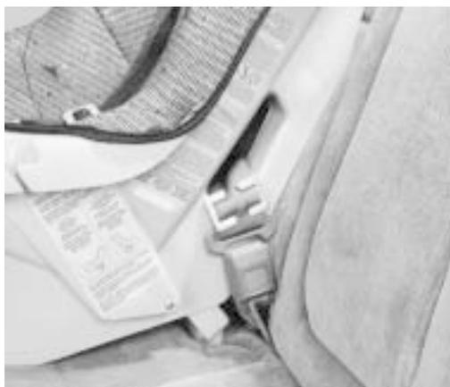
5. La patte d'ancrage bien installée par-dessus les deux parties de la ceinture de sécurité, insérer de nouveau la plaque du loquet dans la boucle. Pousser sur le siège d'enfant ou poser un genou ou les deux sur le siège d'enfant tout en tirant sur la ceinture et en glissant le baudrier dans l'enrouleur.
