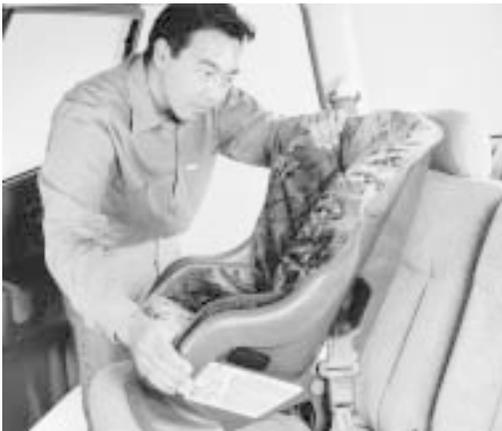
4. Pousser et tirer le siège d'enfant vers l'avant et d'un côté à l'autre pour confirmer qu'il est attaché assez solidement pour rester en place pendant les manoeuvres normales de la conduite.
