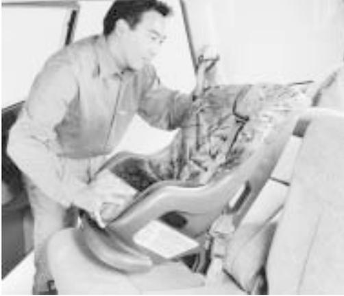
2. Si la ceinture de sécurité est munie d'un enrouleur à blocage (tel que représenté ici), pousser le siège d'enfant plus loin vers l'arrière tout en tirant sur le baudrier et en l'enroulant le plus possible.
