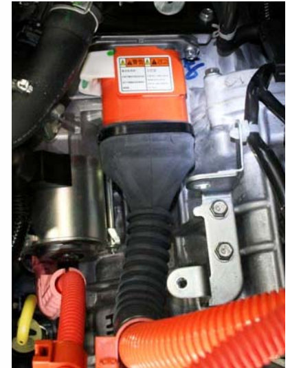
Branchement des câbles haute tension au moteur
